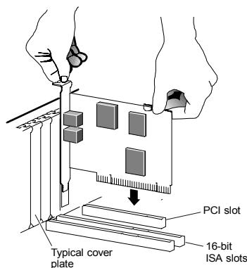
Verifique que el extremo posterior de la tarjeta (el área dorada más corta) está bien asentada en el conector. Si tiene una carcasa de ordenador de tipo torre o minitorre con una placa principal vertical, acueste el ordenador sobre su lateral para poder presionar hacia abajo la tarjeta del módem de modo que se asiente firmemente en su ranura. Compruebe que la escuadra está correctamente alineada y a continuación atornille la escuadra en el ordenador empleando el tornillo que quitó antes.
