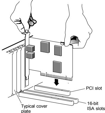
Vérifiez que l'arrière de la carte (pattes dorées) est bien en place dans le connecteur. Si votre boîtier d'ordinateur est du type tour ou minitour, avec une carte-mère verticale, couchez-le sur un côté afin de pouvoir appuyer par le haut sur la carte modem pour l'enfoncer solidement dans son emplacement. Vérifiez que le support est correctement aligné puis vissez-le sur l'ordinateur, à l'aide de la vis que vous avez enlevée pour dégager l'emplacement.
