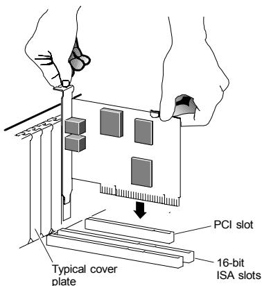
Vergewissern Sie sich, dass das hintere Ende der Karte (kleinerer Goldfingerbereich) richtig auf den Anschlüssen aufsitzt. Wenn Sie einen Tower oder Mini-Tower Computer mit einer vertikalen Hauptplatine haben, legen Sie den Computer auf die Seite, damit Sie die Modemkarte direkt nach unten drücken können und sie fest in ihrem Steckplatz sitzt. Vergewissern Sie sich, dass die Klammer richtig sitzt und schrauben Sie sie mit der von vorher aufgehobenen Schraube am Computer fest.
