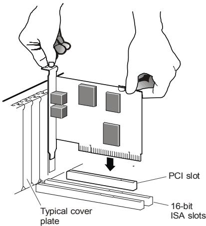
PCI slot = PCI-uttag, Typical cover plate = Typisk täckplåt
