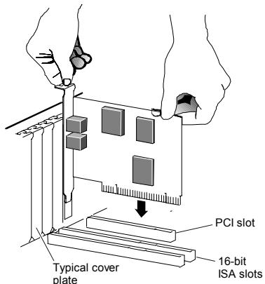
Assicurarsi che l'estremità posteriore della scheda (area contatti) sia saldamente inserita nel connettore. Se si dispone di un computer tower o mini-tower con scheda madre verticale, appoggiare il computer sul fianco e spingere la scheda modem per inserirla saldamente nello slot. Assicurarsi che il supporto sia correttamente allineato, quindi avvitare il supporto nel computer utilizzando la vite precedentemente rimossa.
