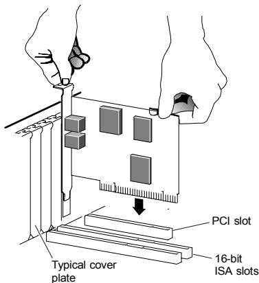
Verifique se a extremidade da placa (pequena área dourada) está bem introduzida no conector. Se tiver um computador tipo torre ou mini-torre com uma placa principal vertical, coloque o computador de lado para que possa empurrar a placa do modem correctamente para baixo e encaixá-la bem na respectiva ranhura. Certifique-se de que o suporte está alinhado correctamente e, em seguida, prenda o suporte ao computador com o parafuso que retirou anteriormente.
