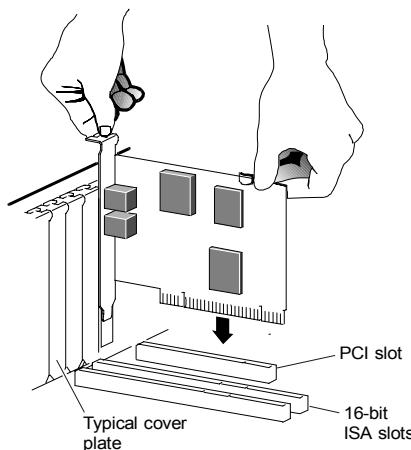
Controleer of het achtereinde van de kaart (het kleinere goudvingergebied) correct is geplaatst in de connector. Leg, wanneer u een tower- of minitowercomputerkast met een verticaal hoofdpaneel hebt, de computer op zijn kant zodat u
