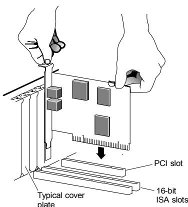
Upewnij się, czy tylna część karty jest docisnięta i tkwi w złączu. Jeśli masz obudowę typu 'tower' lub 'mini-tower' z pionową płytą główną, położ komputer na boku tak, aby móc wygodnie wcisnąć kartę w złącze. Następnie przymocuj kartę używając poprzednio odkręconej śrubki.
